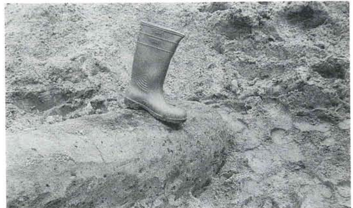
Abb. 2: Ausgegrabener Pfahlfuß eines Pfahles der Grundsatzprüfung
